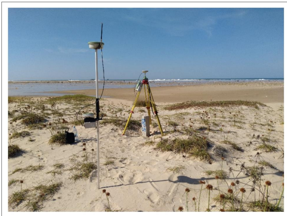
Fig. 2 : Aperçu d'un dispositif GPSD Leica pour lever topographique de précision
